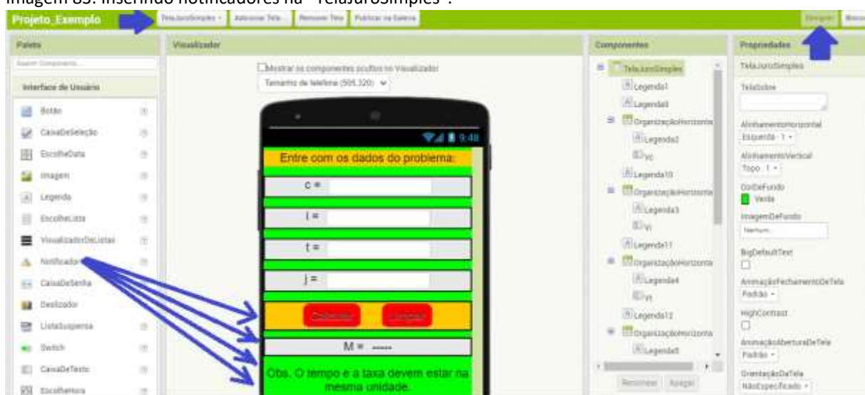
Imagem 83: Inserindo notificadores na “TelaJuroSimples”.
