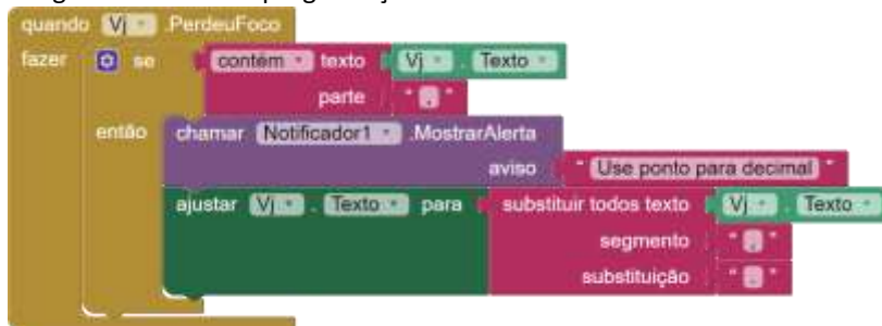
Imagem 84: Bloco de programação do “Notificador1”.
