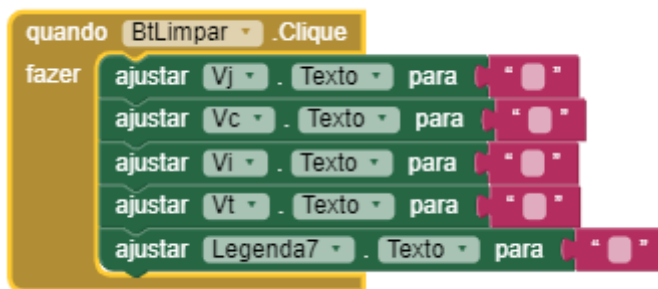
Imagem 66: Bloco final do “BtLimpar”.
