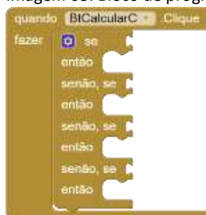
Imagem 68: Bloco de programação com as condições lógicas.
