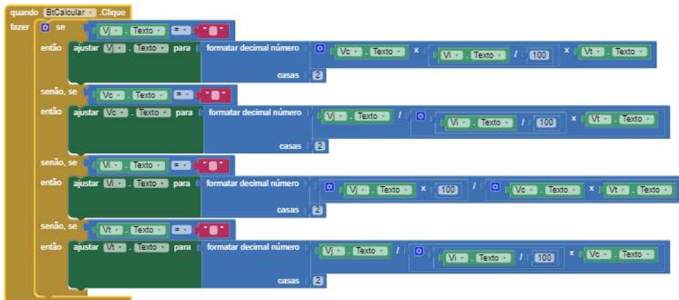
Imagem 60: Bloco de programação com o “Vi” e o “Vt” inseridos.
