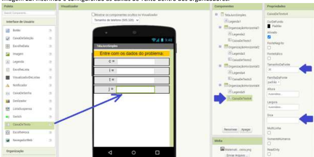
Imagem 22: Inserindo e configurando as Caixas de Texto dentro dos organizadores.
