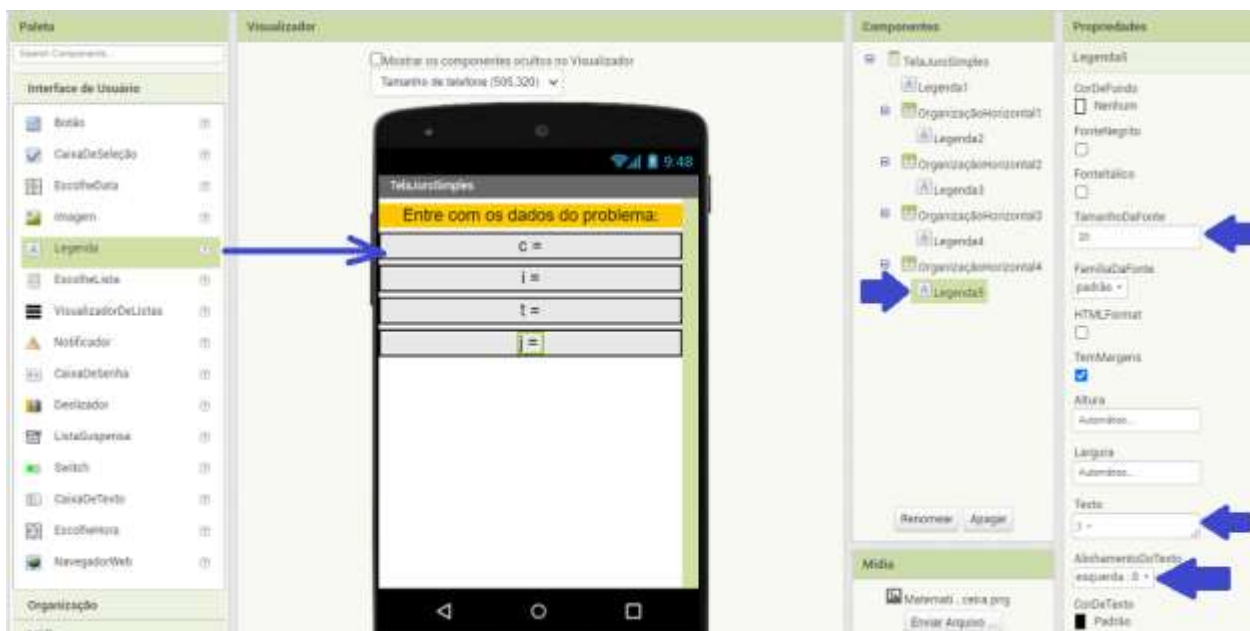
Imagem 22: Inserindo e configurando as Caixas de Texto dentro dos organizadores.
