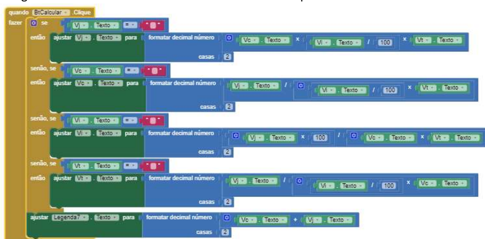
Imagem 62: Bloco final do “BtCalcular” da “TelaJuroSimples”
