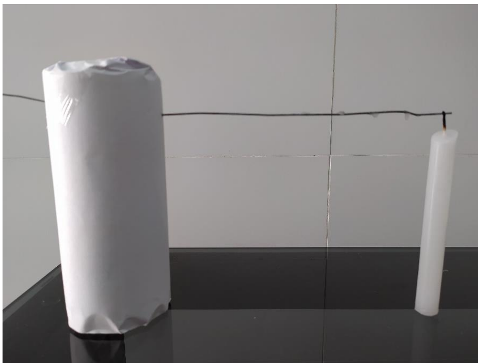
Figura 12 – propagação por condução
