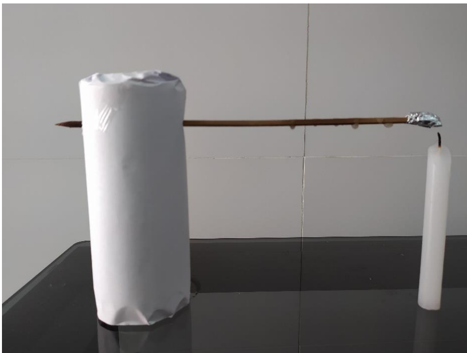
Figura 13 – propagação por condução
