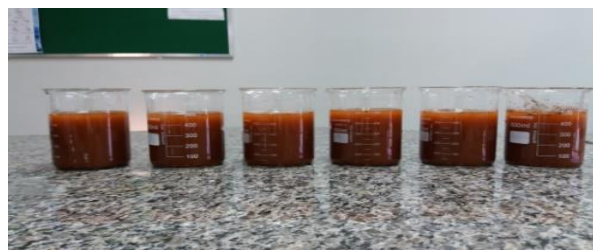
Figura 7 – Início da clarificação manual da água Fonte – Próprio autor
