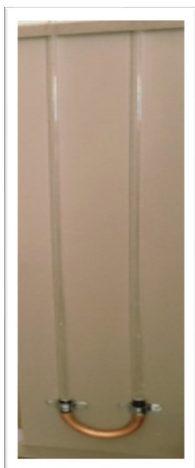
Figura 07: Fixação do tubo em “U” na base de MDF
