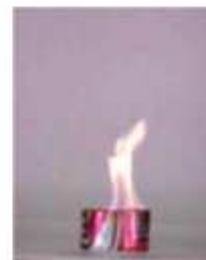
Figura: lata recortada + etanol em combustão
