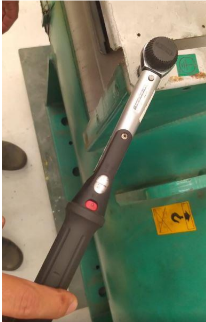
Figura 9. Aplicando 10 NM torquímetro certificado
