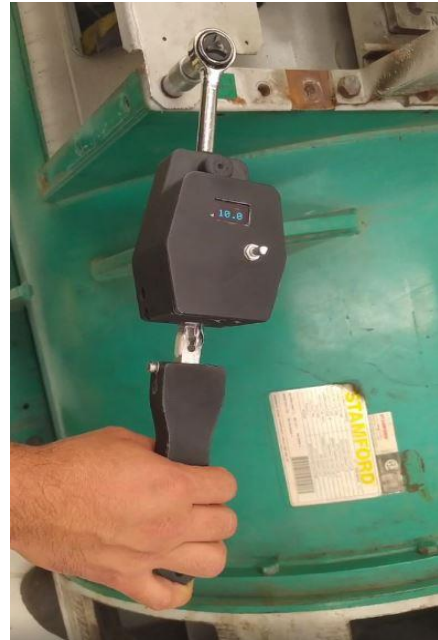
Figura 10. Aplicando 10 NM torquímetro certificado
