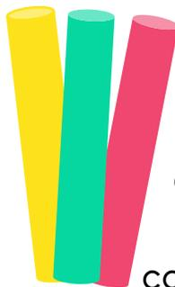
O **espaguete termorretrátil** será utilizado para isolamento nas emendas dos cabos. Pode ser aquecido com soprador térmico ou isqueiro, que é mais acessível.
