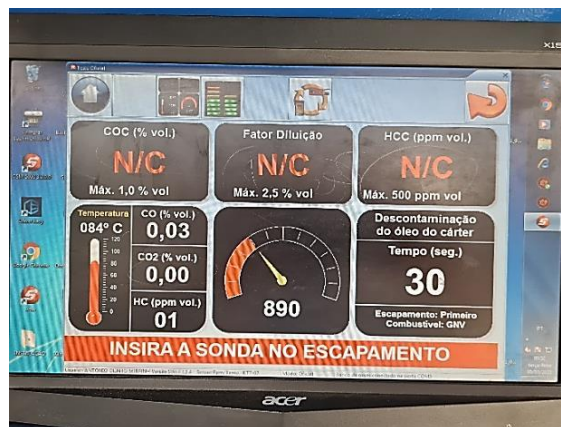
Figura 3. Etapa de inserir sonda no escapamento
