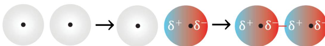
Figura 2-Representação da indução de um dipolo em um composto apolar
