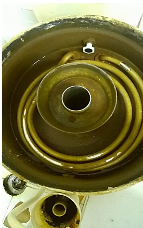
Figura 3 - Interior do destilador antes da higienização
