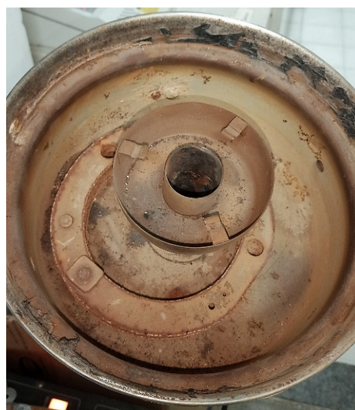
Figura 4 - Interior do destilador sem limpeza por muitos anos
