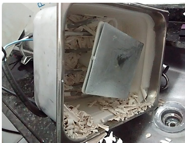
Figura 5 – Destilador com depósito de bicarbonato de cálcio
