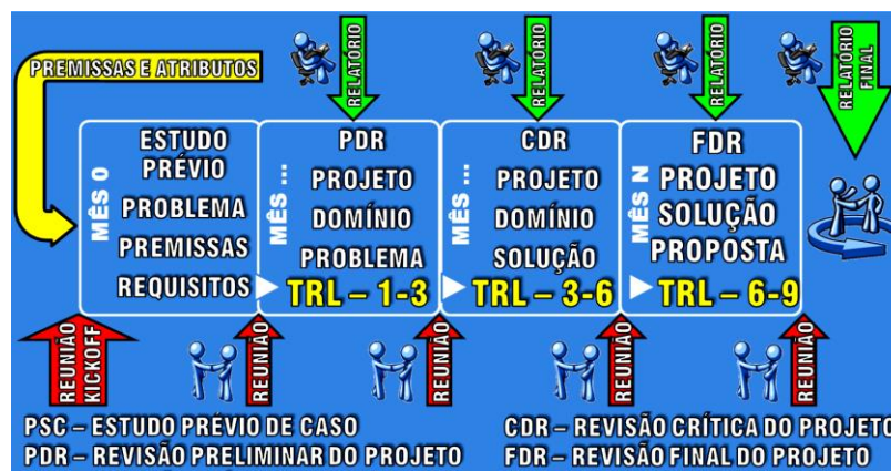
Figura 4. Etapas de evolução de projetos em Eng. de Sistemas & Requisitos. Fonte: Próprio Autor (2022).
