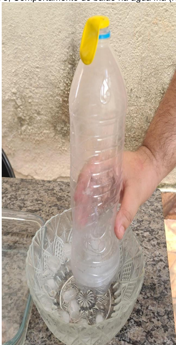
Figura 24 - Prática 3, Comportamento do balão na água fria (redução de volume).
