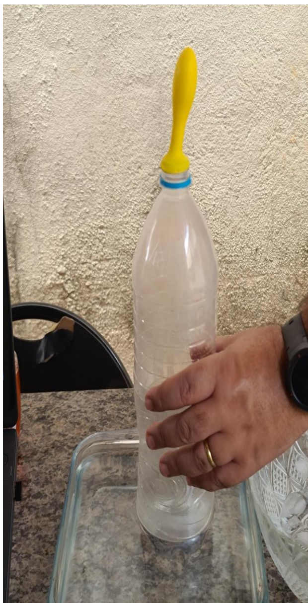
Figura 23 - Prática 3, Comportamento do balão na água quente (aumento de volume)
