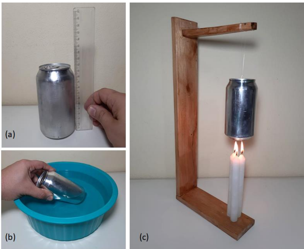
Figura 40 — Etapas de construção e realização do experimento da máquina térmica de Heron.
