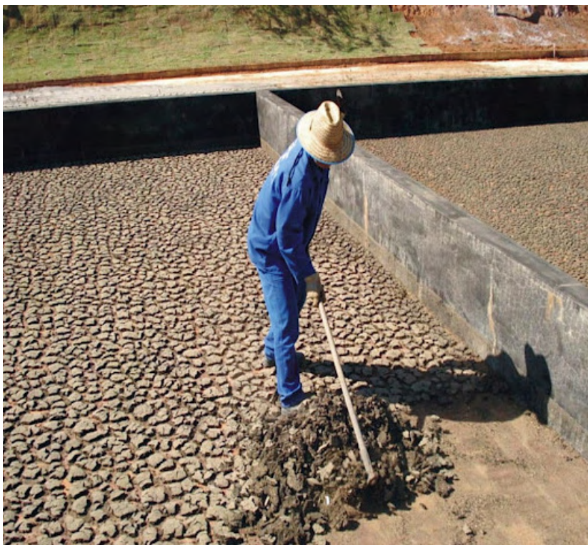
Figura 17: Leito de secagem de lodo.
