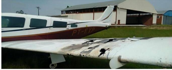
**Figura 3:** Aeronave suspeita submetida a tiro de detenção. Fonte: revista *Tecnologia e Defesa*. Fonte: site *tecnodefesa FAB*.
