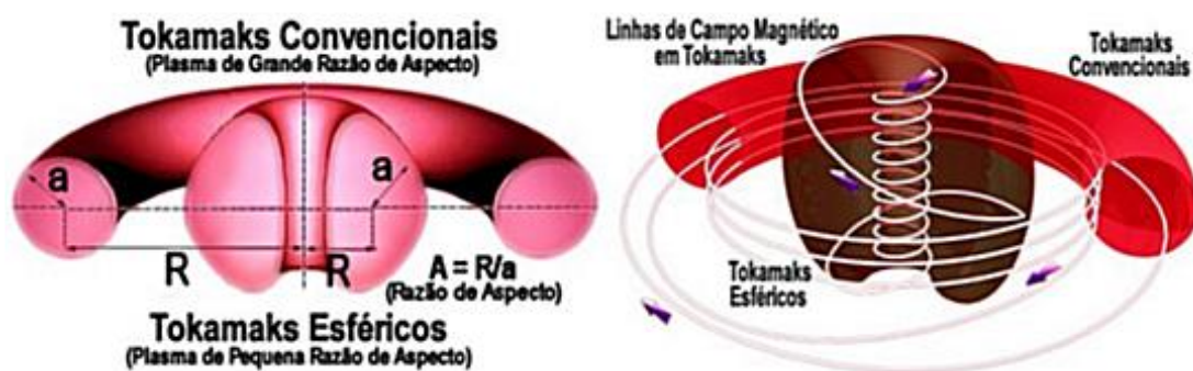
Figura 5. Diferenças geométricas entre as colunas de plasmas e linhas de campo magnético em Tokamaks (Convencional e Esférico).
