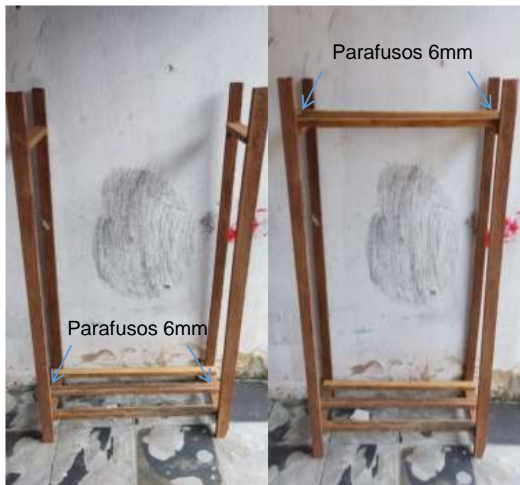
Figura 3 – Montagem da base de fixação com os parafusos.
