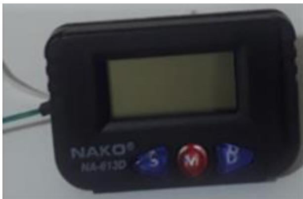
Figura 4.9 Relógio digital utilizado como carga a ser acionada pela célula solar. Fonte: próprio autor.
