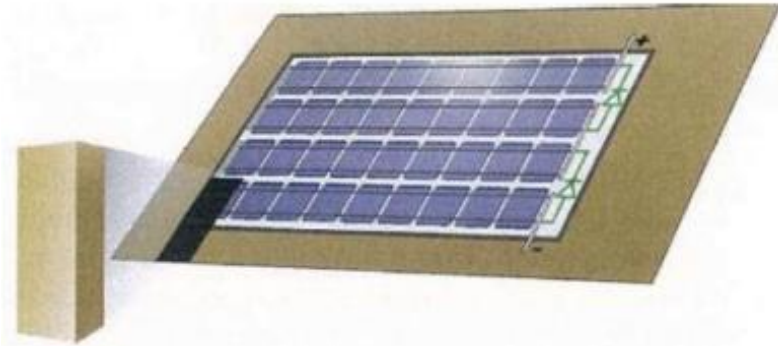
Figura B. Sombreamento de uma célula FV dentro de um módulo FV Fonte: PLANNING AND INSTALLING PHOTOVOLTAIC SYSTEMS. A guide for installers, architects and engineers. Londres, 402 p. 2008.
