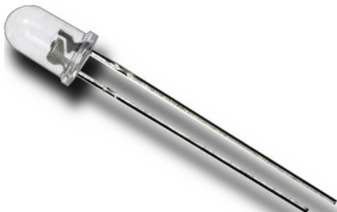
Figura 2.3-Esquema de um fototransistor.
