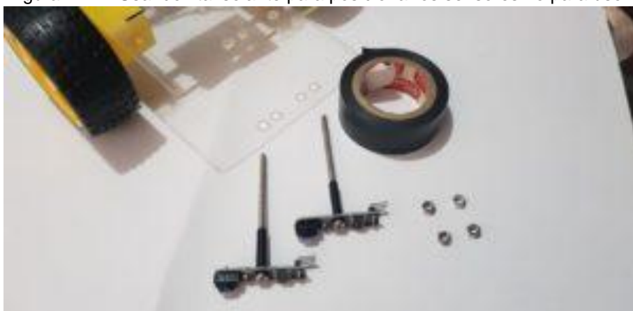
Figura 2.44 - Usando fita isolante para posicionar os sensores no parafuso.
