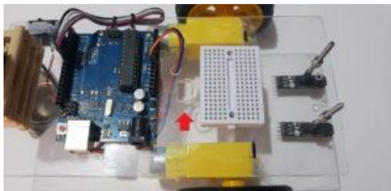
Figura 2.47 - Espaço furado para passar jumpers.
