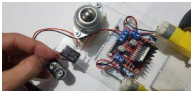
Figura 2.35 - Conexões para alimentação do driver.
