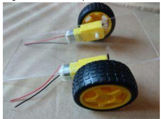
Figura 2.5 - Rodas acopladas nos motores.
