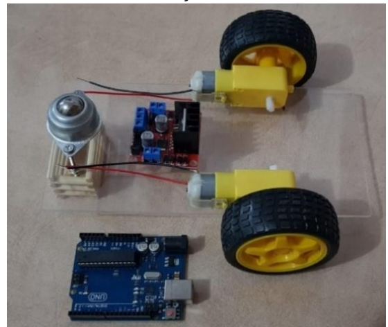
Figura 2.20 - Posicionando placa L298N para fixação.
