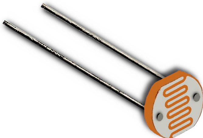
Figura 2.4-Esquema de um LDR.
