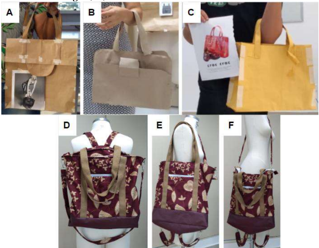
Figura 02 – Bolsa. A, B e C: Molde em papel com modelo definido para a montagem; D, E e F: Bolsa versátil em tecido finalizada.
