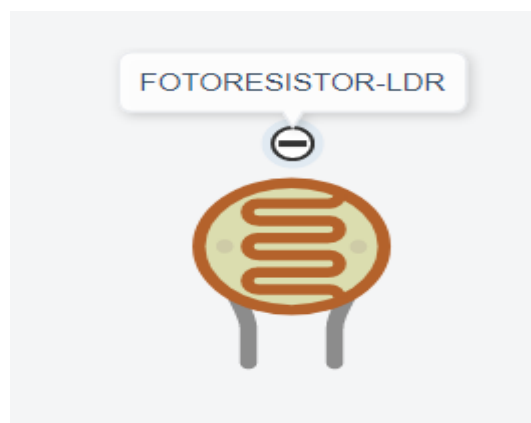
Figura 13 - Sensor de luminosidade fotoresistor.
