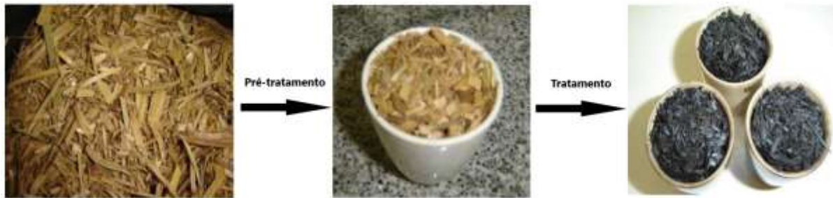
Figura 4. Demonstração do pré-tratamento, do material após do tratamento e do biocarvão produzido.
