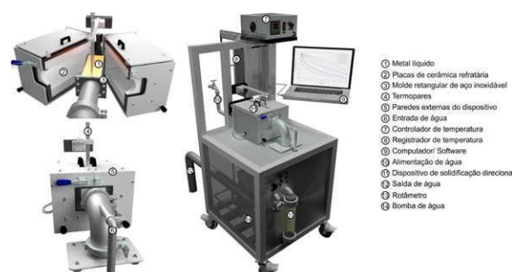
Figura 1. Conjunto completo do dispositivo de solidificação horizontal refrigerado à água.
