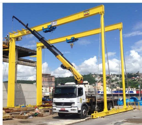
Figura 1. Ponte de transporte de cargas. Fonte: https://atriumetal.com.br/porticos-rolantes-o-futuro-inteligente-da-movimentacao-de-cargas/
