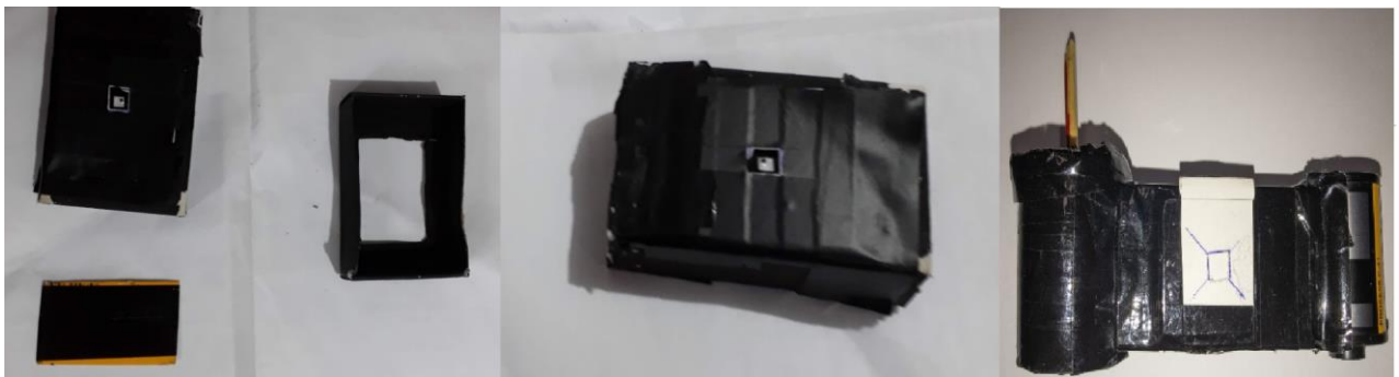
Figura 24 - Etapas da Montagem da câmera Pinhole
