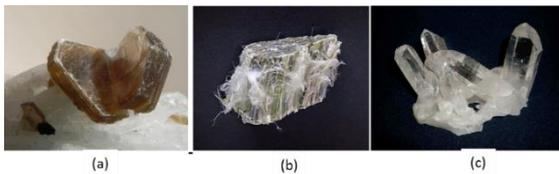
Figura 7: Alguns exemplos de hábito cristalino: (a) Laminar (mica); (b) Fibroso (Crisotilo); (c) Prismático (Quartzo)
