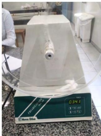
Figura 4 – Equipamento Friabilômetro utilizado para teste de Friabilidade.
