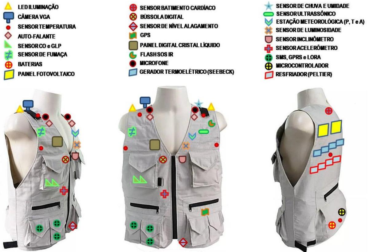
Figura 4. Distribuição dos sensores utilizados no protótipo do colete.
