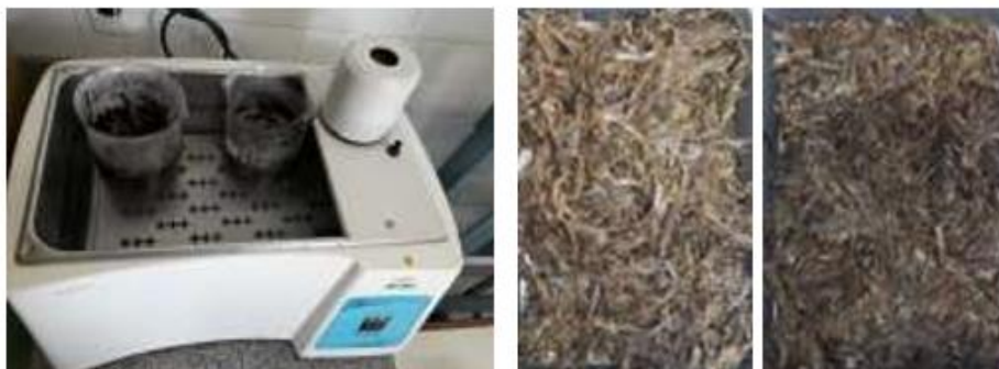
Figura 1: Processo do tratamento das fibras de buriti e a secagem das fibras em temperatura ambiente
