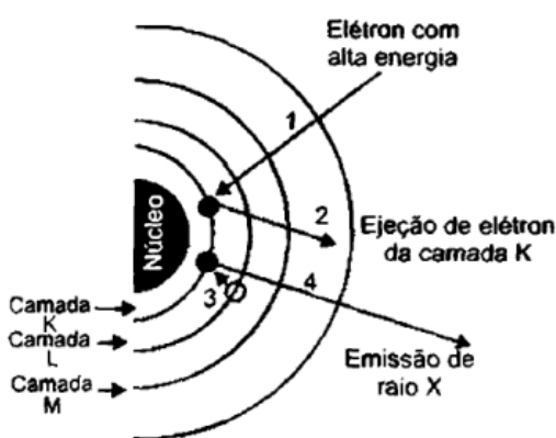
Figura 1 - Ilustração de emissão de raios X de um átomo.
