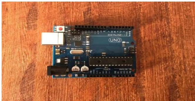
FIGURA 4 – Placa Arduino Uno.
