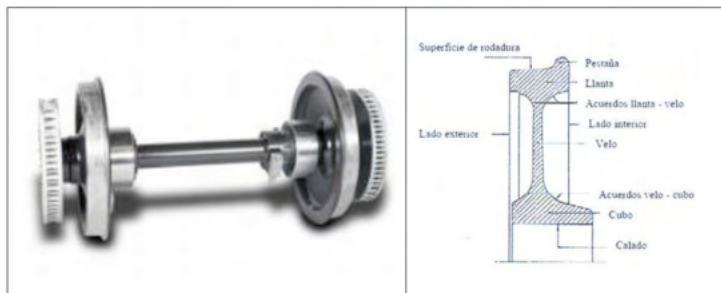
Figura 3: Ejes 3 y perfil 4 de rueda.
