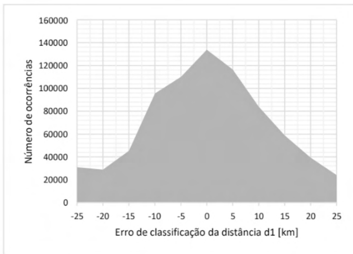
Figura 8 - Erro de estimação da distância da falta em função da impedância Z_1 para o conjunto de dados de validação.
