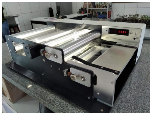
Figura 5. Medidor modelo LI-3100C do Laboratório de Fitotecnia do Ifes – Alegre pronto para medição
