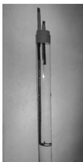
Fig. 4. Celda de vidrio y alambre de platino.
