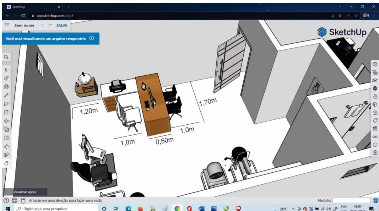
Figura 27 – Consultório dimensionado de acordo com as especificações do problema: Distanciamento e medidas, observando as sobras para pia e movimento de porta, conforme solicitado. Fonte: Acervo pessoal
