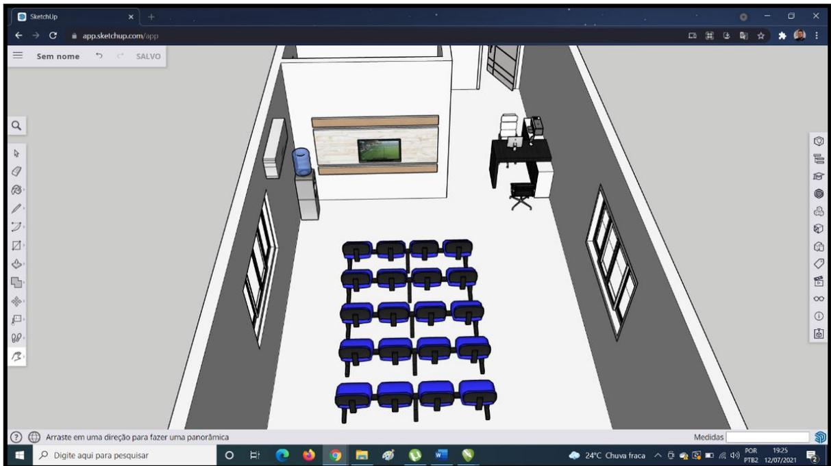
Figura 21 – Sala de espera, com 1,50m na lateral direita e 1,20m na lateral esquerda, respeitando a acessibilidade, visão de cima. Fonte: Acervo pessoal.
