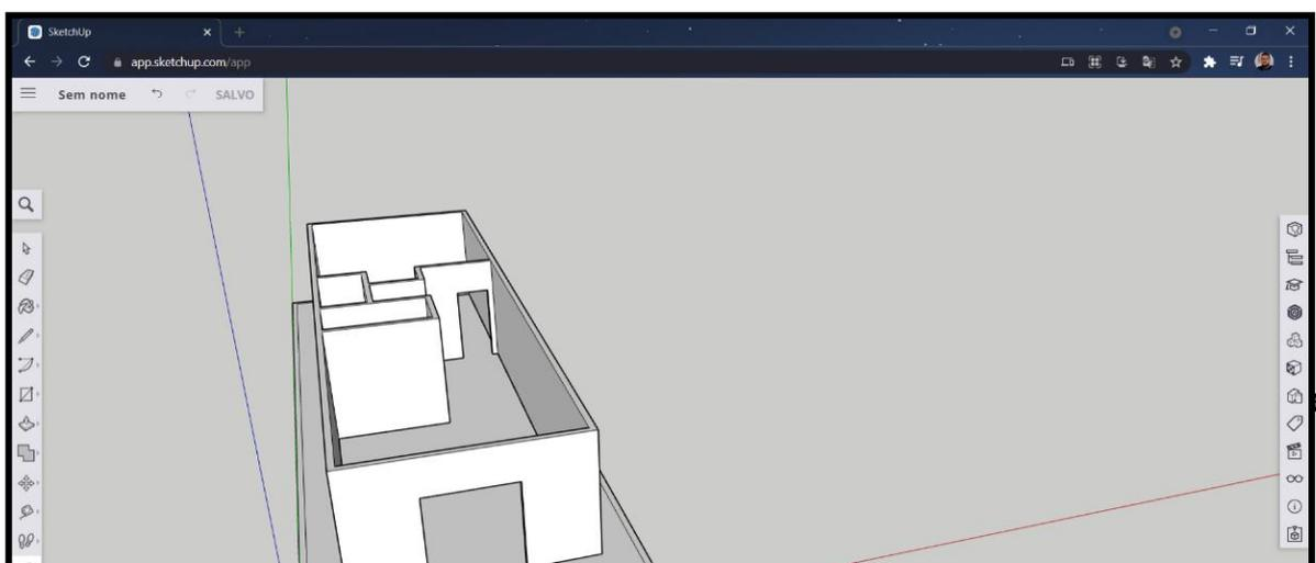
Figura 19 – Levantamento das paredes respeitando a altura mínima, de 3,0 metros, conforme problema. Fonte: Acervo pessoal.
