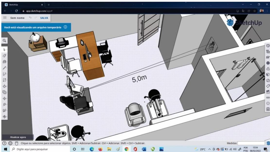
Figura 24 –Distância de atendimento com cadeira posicionada a 5m da tabela de optotipos, conforme flexibilidade de até 3,50m solicitada. Fonte: Acervo pessoal
