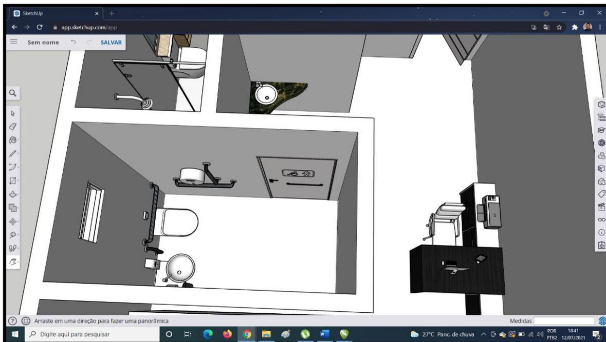
Figura 28 – Banheiro público com acessibilidade, com porta dimensionada a 0,90 m de largura. Fonte: Acervo pessoal.
