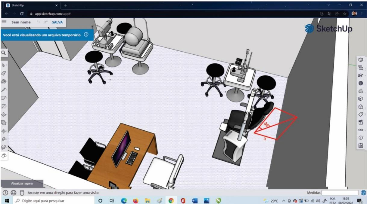
Figura 25 – Consultório dimensionado de acordo com as especificações do problema: Distância de atendimento a 6,10m da tabela de optotipos, com sobra de 0,50m para trás, reclinção de 30°, conforme solicitado. Fonte:
