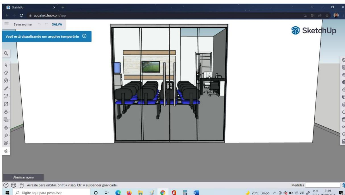
Figura 22 – Porta de vidro com medidas 0,52m cada e vão 2,08m por 2,10m.
