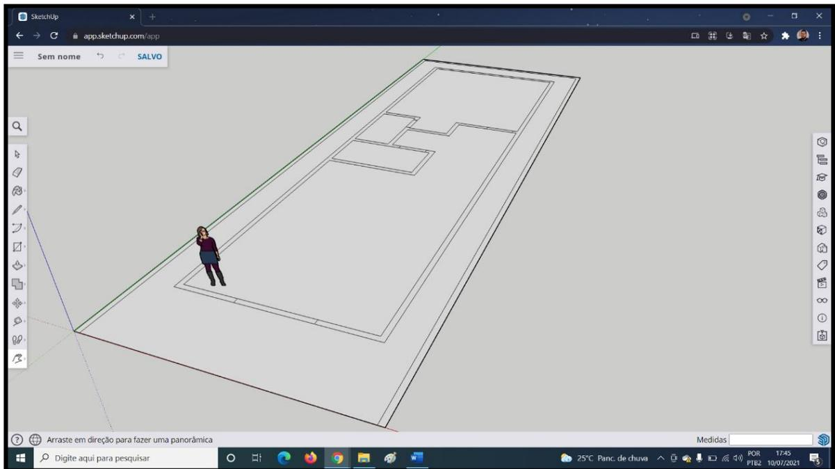
Figura 18 – Delimitação das divisórias e paredes da planta baixa, conforme descrição do problema e espaçamento frontal de 2,0 metros. Fonte: Acervo pessoal.
