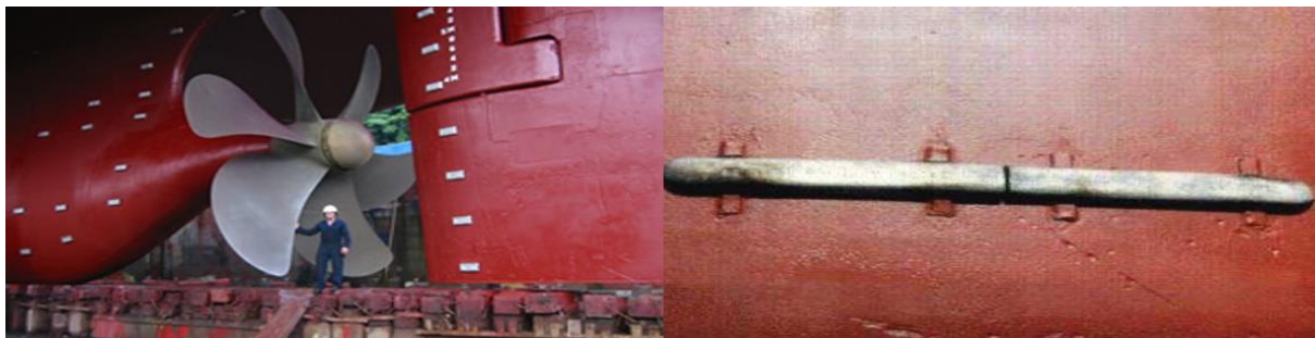
Figura 4 – Casco de navio revestido com placas de zinco (a esquerda), zoom do metal de sacrifício (a direita).
