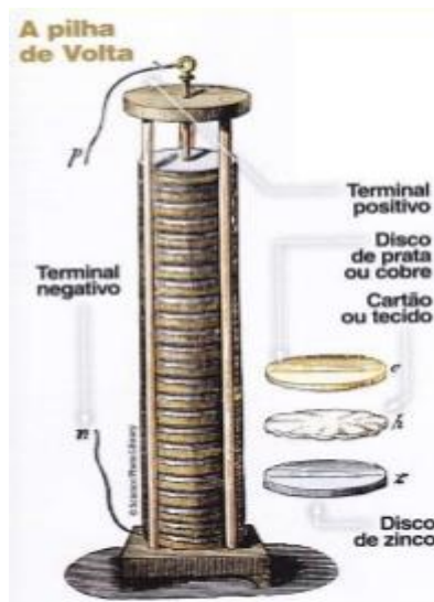
Figura 1 - Pilha de Alessandro Volta
