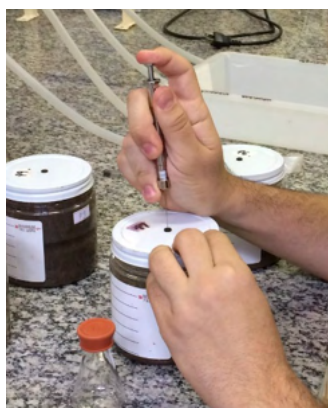
Figura 4. Amostragem dos gases com seringa cromatográfica.
