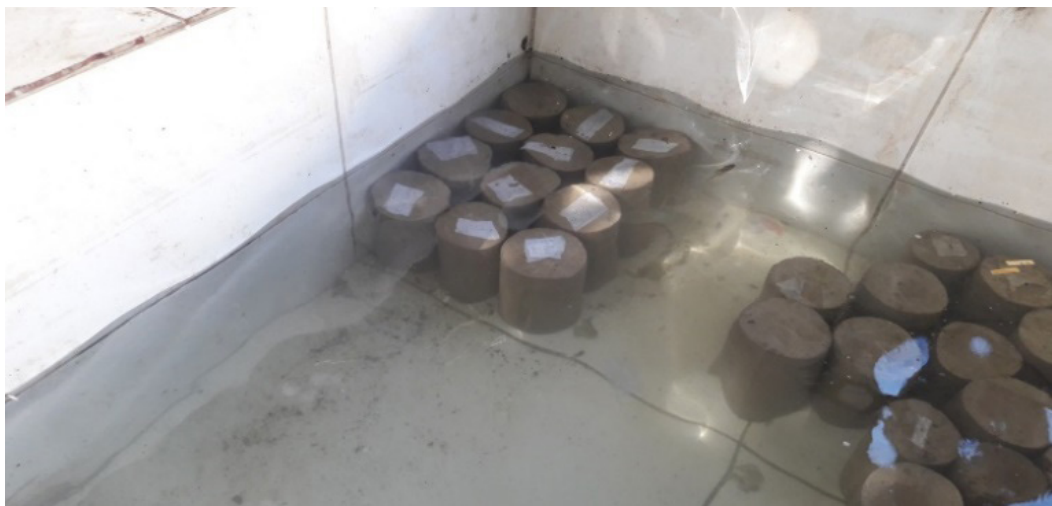
Figura 3: Corpos de prova imersos na água
