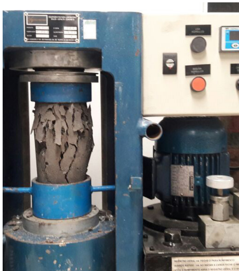
Figura 7: Corpo de prova após rompimento
