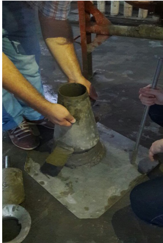
Figura 2: Teste de slump
