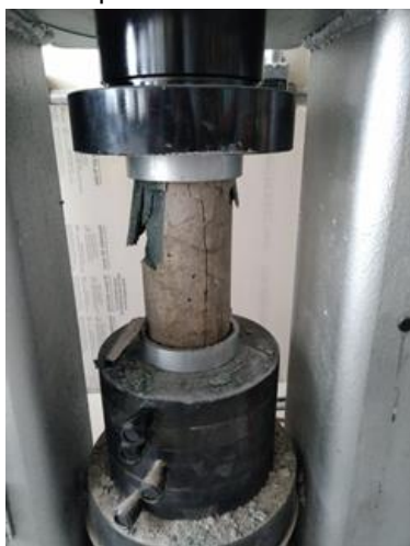
Figura 4 - Momento de ruptura do corpo de prova monitorado
