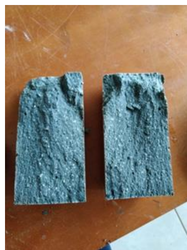
Figura 5 - Estado do corpo de prova após o ensaio de compressão
