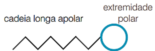
Figura 11. Representação da estrutura básica de um íon molecular de sabão ou detergente. Fonte: adaptado de FILHO et al. (1999).
