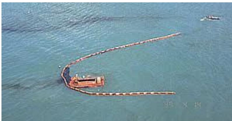
Figura 3. Contenção e remoção de petróleo no mar com barcaça recolhadora. Fonte: CETESB. Disponível em: https://cetesb.sp.gov.br/emergencias-quimicas/tipos-de-acidentes/vazamentos-de-oleo/acoes-de-resposta/contencao-e-remocao/ . Acesso em: 03 fev. 2021.
