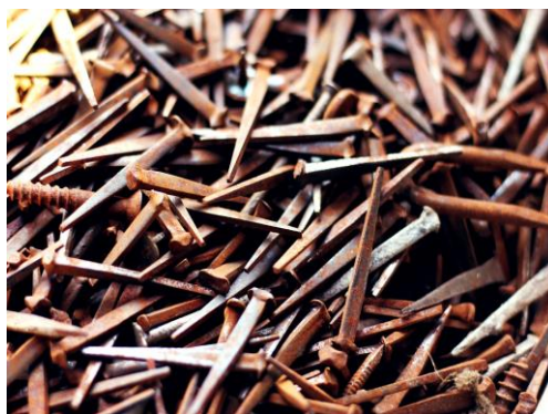
Figura 19. Escala Corrosão de pregos causa pela reação de oxidação -redução de ferro (Fe) com oxigênio ( O_2 ) presente
