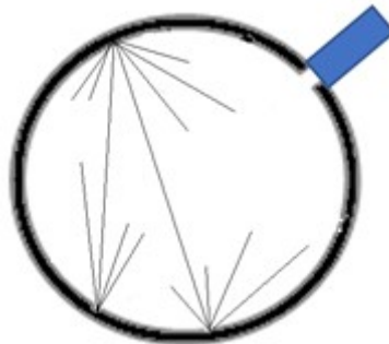
Figura 1 – Representação de um corpo negro. Emissão e absorção de radiação térmica por todos os pontos da cavidade. Em azul, um sensor de radiação.
