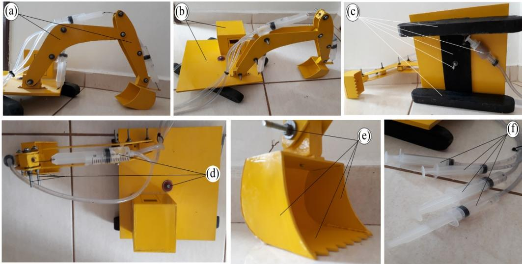
**Figura 13** – Peças e escavadeira hidráulica; (a) braços de sustentação – os moldes são disponibilizados; (b) base e cabine de controle; (c) esteiras, base retangular, parafuso do eixo central e cano de sustentação da seringa (d) rolamento da base central, seringa de 10 ml, parafusos de fixação dos braços (e) parafuso de sustentação da caçamba e faces da caçamba (f) seringas controladoras da escavadeira.
