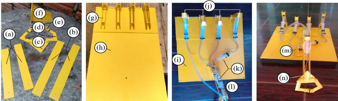
**Figura 11** - Peças e braço hidráulico; (a) peças de 20cm x 3cm; (b) peças de 25cm x 3cm; (c) um triângulo equilátero medindo 9cm; (d) duas peças de 5cm x 7cm; (e) duas peças de 7cm; (f) uma peça de 6,5cm x 8cm e duas peças de 10cm x 7cm; (g) uma peça de 45cm x 38cm; (h) 8 peças de 2,5cm x 3cm e oito peças de 2cm x 2,5cm; (i) uma peça de 45cm x 38cm; (j) quatro seringas de 20ml; (k) duas seringas de 10ml; (l) duas peças 16cm x 4cm; (m) rolamento; (n) um triângulo equilátero medindo 9cm.
