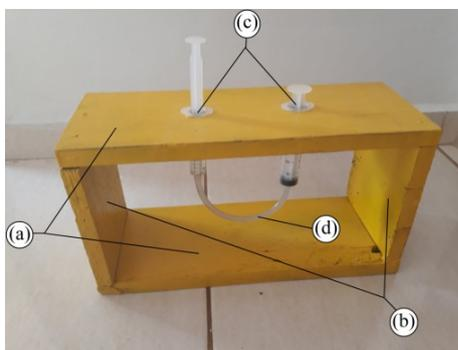
**Figura 12** – Peças e elevador hidráulico; (a) 2 peças de 35cm x 13,5cm; (b) 2 peças de 15cm x 13,5cm; (c) 2 seringas sendo uma de 20ml e outra de 10ml; (d) mangueira de aquário ou similar medindo aproximadamente 20cm de comprimento e 11mm de diâmetro.
