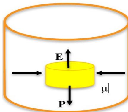
**Figura 9** – Esquema da aplicação da força de empuxo em um cilindro. Fonte: adaptado de Pauli et al. (1978).
