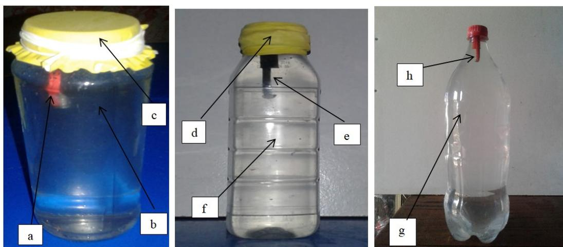
**Figura 15** – Peças e modelos de ludião; (a) tampa de caneta com um pequeno parafuso preso em sua extremidade; (b) frasco de vidro cheio de água; (c) luva de látex presa com tiras da própria luva; (d) luva de látex presa com elástico de escritório; (e) tampa de caneta com um pequeno parafuso preso em sua extremidade; (f) garrafa pet 500 ml; (g) garrafa pet 2 l; (tampa de pincel com uma pequena porca presa).
