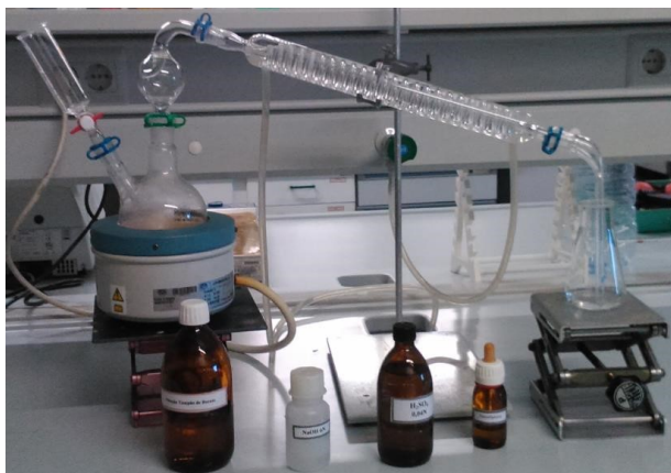
Figura 3.5 - Instalação experimental para a destilação da amostra
