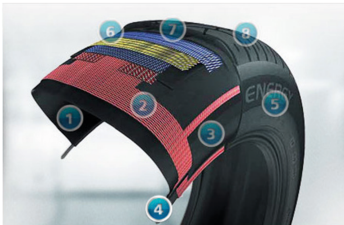
Figura 1 – Esquemática das camadas componentes do pneu automotivo. 1) Revestimento interno, 2) Carcaça, 3) Zona baixa, 4) Aro do talão, 5) Flanco externo, 6) Lonas de topo, 7) Lona zero graus, 8) Banda de rodagem
