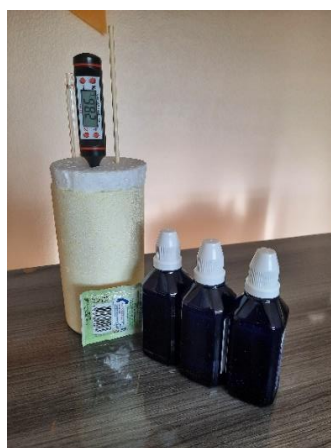
Imagem: calorímetro simples com termômetro digital de espeto (Autor).
