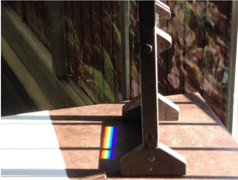
Figura 5 - Dispersão da luz branca por um prisma.
