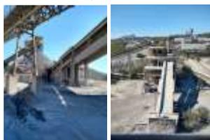
Fig. 4: a) Chegada de pedras da mina. b) Britadores de brita 2, 1, pedrisco e pó (carrão).
