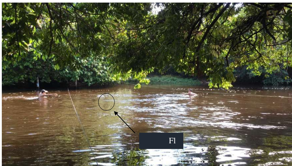
Figura 7. Lançamento do flutuador na SM para estimativa do tempo.
