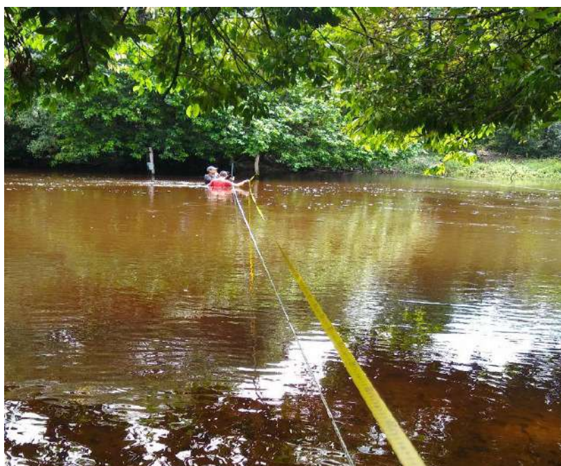
Figura 5. Medição da largura total da seção de medição com fita métrica.
