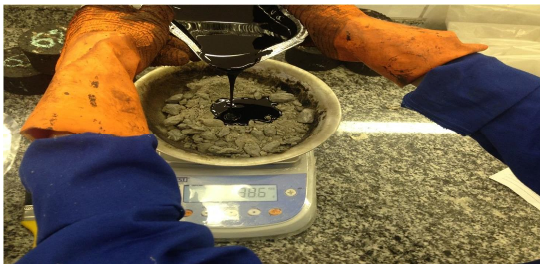
Figura 3 – Ligante tipo asfalto-borracha sendo misturado ao agregado
