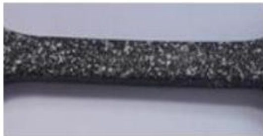
Figura 1 – Corpo de prova com pintura.
