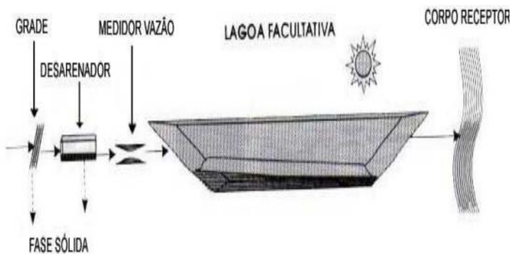
Figura 7 - Esquema de uma lagoa facultativa
