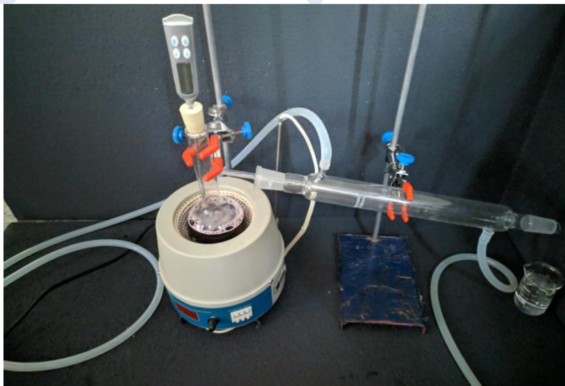
Figura 19 – Sistema de destilação simples. Tem-se uma mistura homogênea no balão de destilação (suco de uva). Ao aquecer o sistema a 100°C a água da mistura evapora (gás). Passando pelo condensador o vapor de água é condensado sendo obtido ao final água no estado líquido. Fonte: autoria própria.
