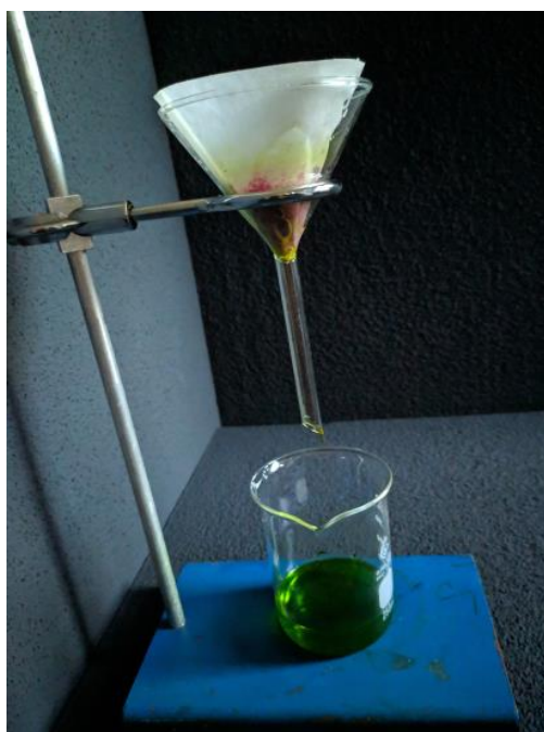
Figura 17 – Processo de filtração do extrato obtido na figura 16. No filtro ficam retidas as partes sólidas. Fonte: autoria própria.
